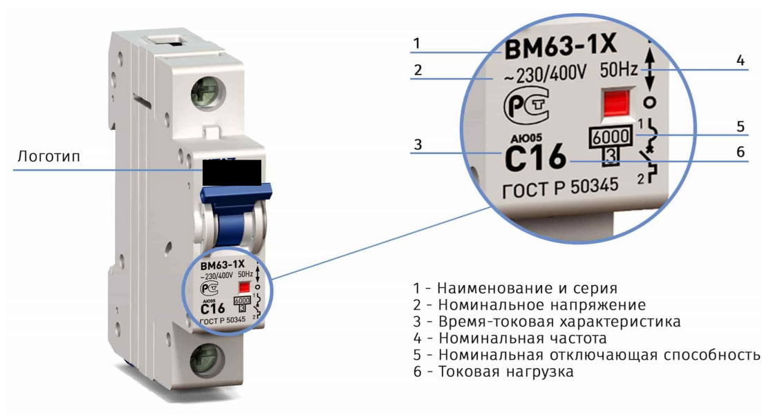
Рисунок 2. Пример маркировки АВ
