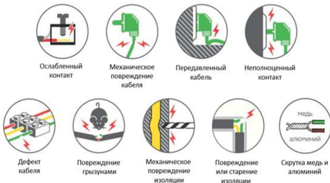
Рисунок 6. Возможные причины искрения в электропроводке
